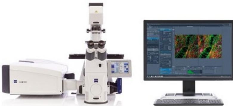
Le système comprend un système de microscopie inversé totalement motorisé et automatisé, équipé d'un statif inversé complet avec lampe de fluorescence fibrée, avec accessoires compatibles chambre d'incubation, contrôle de température et de CO<sub>2</sub>. L'intégration de la gestion du contrôle environnemental et de la platine motorisée se font directement sur l'écran TFT du système.
